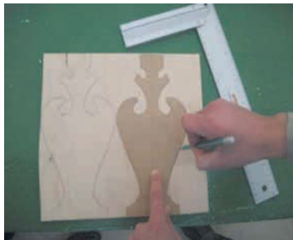
Рис. 67. Разметка с помощью шаблона (условной мерки)
