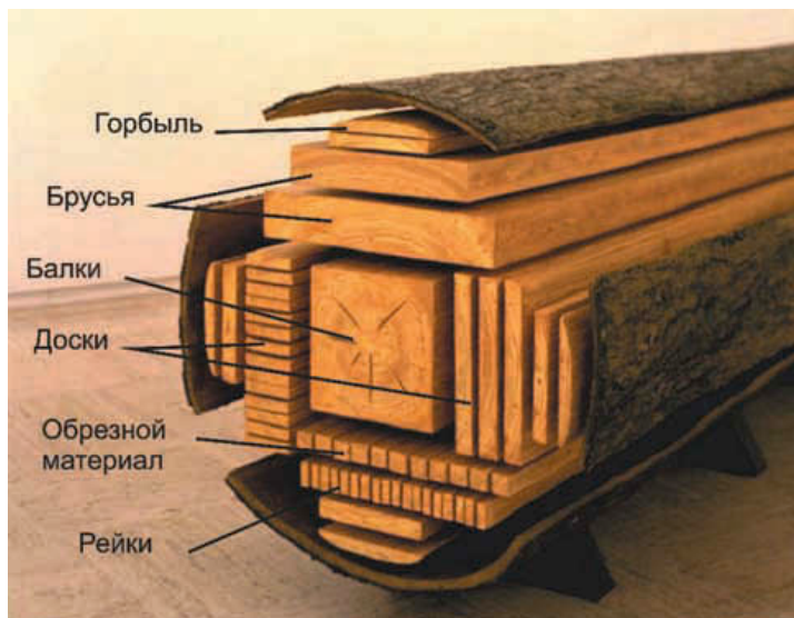
Рис. 58. Пример распиливание на части ствола дерева
