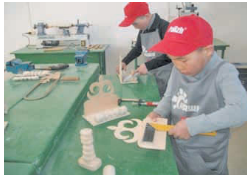
Рис. 67. Разметка с помощью шаблона (условной мерки)
