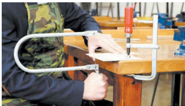
Рис. 72. 1. Выпиливание лобзиком. 2. Струбцина
