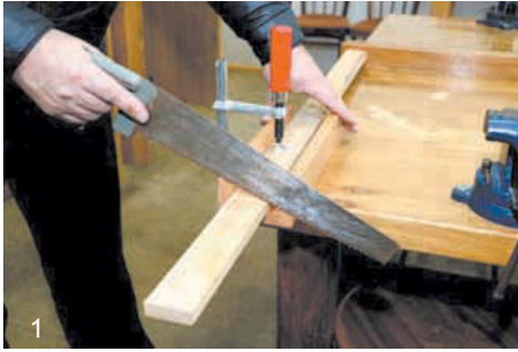
Рис. 68. 1- пиление с упором; 2 – пиление в стусле
